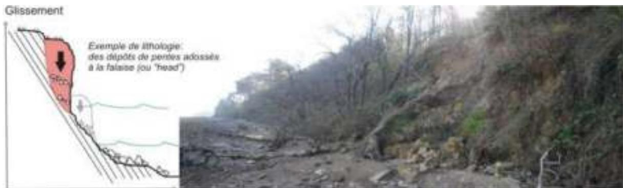
Illustration 21 - Schéma de principe d'un glissement de terrain (Landevennec, 29) (Schroëtter et Blaise, 2015)
