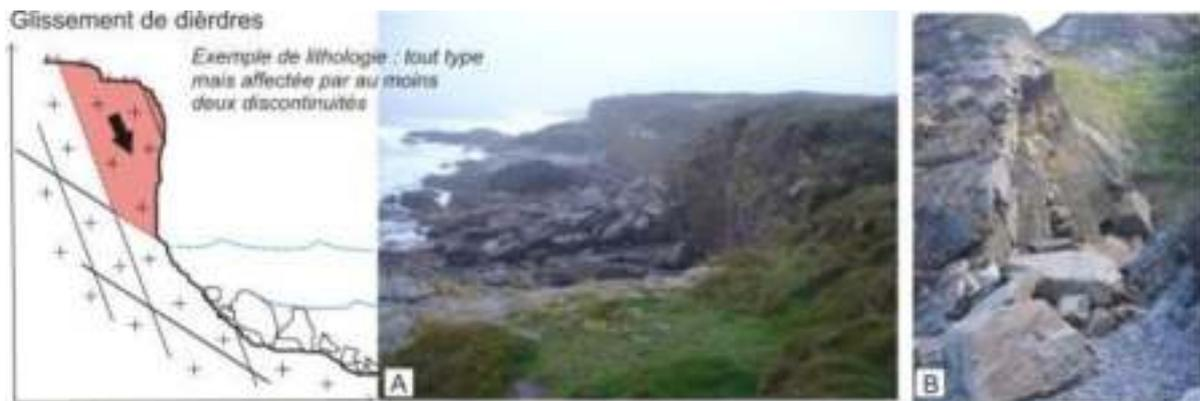
Illustration 23 - Schéma de principe d'un glissement de dièdres (A : Kerfany, 29 ; B : Plouha, 22) (Schroëtter et Blaise, 2015)
