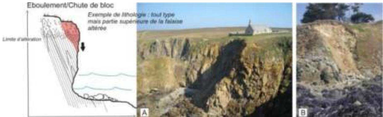
Illustration 24 - Schéma de principe d'un éboulement/Chute de blocs (A : Pointe du Van, 29 ; B : Planguenoual, 22) (Schroëtter et Blaise, 2015)
